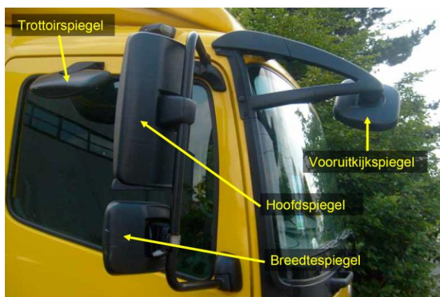
Figuur 4: Systemen voor de detectie van voetgangers en fietsers aan de voor- en zijkanten van vrachtwagens
